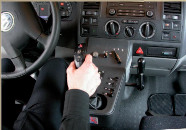
Une poignée centrale contrôle à la fois la direction droite-gauche, l'accélérateur vers l'avant et le frein vers l'arrière.
