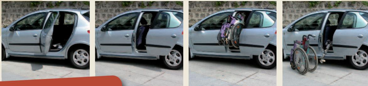
Le robot de coffre charge automatiquement le fauteuil roulant manuel dans le coffre, il commande l'ouverture et la fermeture du hayon arrière. Montage possible sur break et berline avec coffre d'une profondeur de 90 cm. Matériel transférable.
