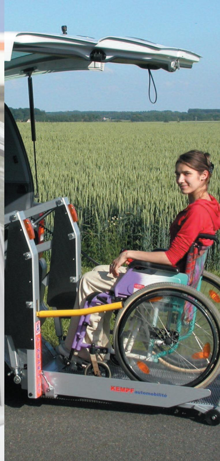
K.automobilité propose toute une gamme de plates-formes élévatrices placées sous le plancher, ou repliables à l'intérieur, en porte latérale, ou arrière...
