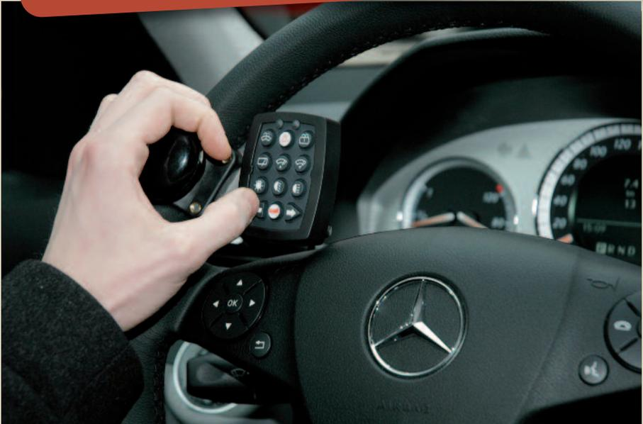
Boule de volant côté main valide avec boîtier de télécommande pour les fonctions d'indicateur de direction, d'avertisseur sonore et lumineux, de commandes des feux : veilleuse, croisement et route, des trois vitesses d'essuie-glace, du lave-glace avant et arrière, de l'essuie-glace arrière et des feux de détresse (warning). Un capteur crépusculaire allume automatiquement les feux de croisement (tunnels, tombée de la nuit, ...)
