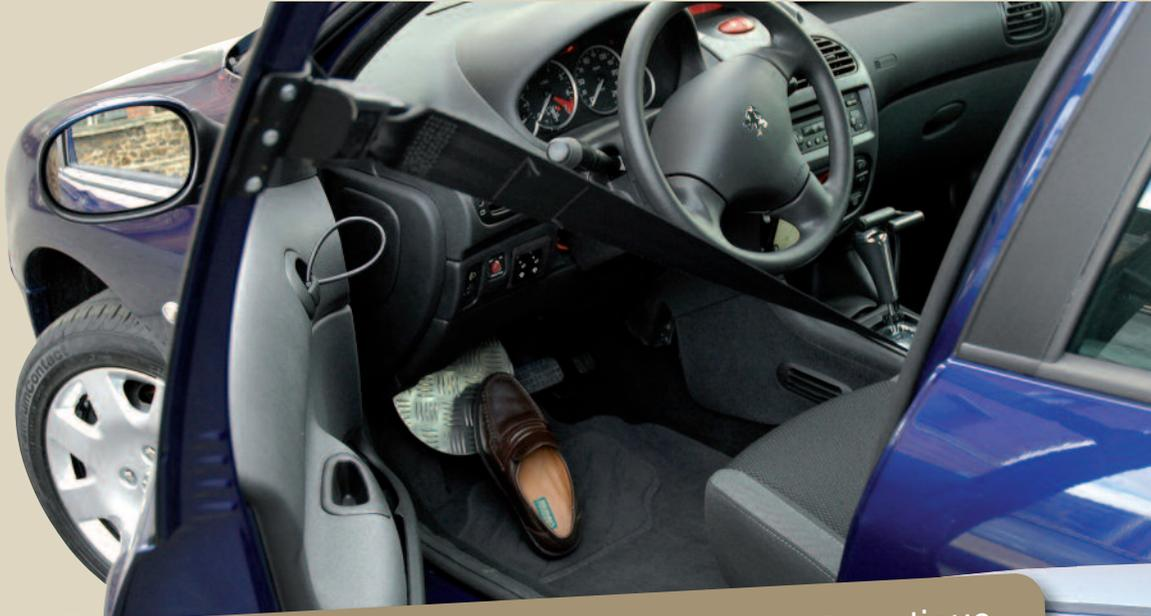
Direction au pied gauche, ceinture passive automatique, levier de vitesses électrique au pied, etc. Aménagement réalisé individuellement "sur mesure"
