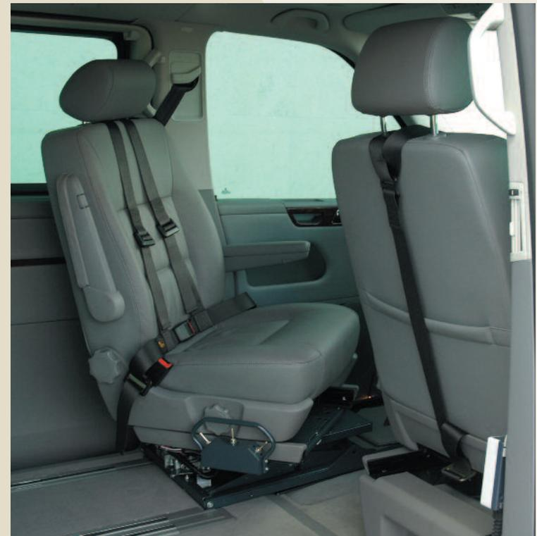
Accéder au poste de conduite en fauteuil roulant électrique avec système d'arrimage homologué, à l'aide d'une embase de siège motorisée 6 fonctions, ou à l'aide d'une planchette de transfert.
