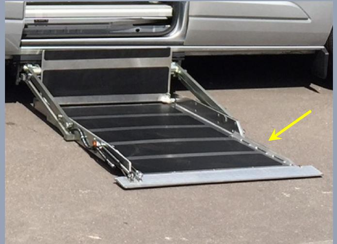
**OPTION : La découpe latérale du plateau permet de faciliter une sortie sur le côté, lorsque que la plateforme se trouve près d'un obstacle.**
