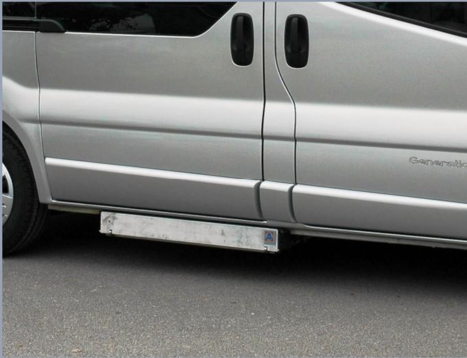
La plateforme K90 se range dans un caisson en inox ultra-plat situé sous le plancher du véhicule, garantissant une garde au sol optimale.
