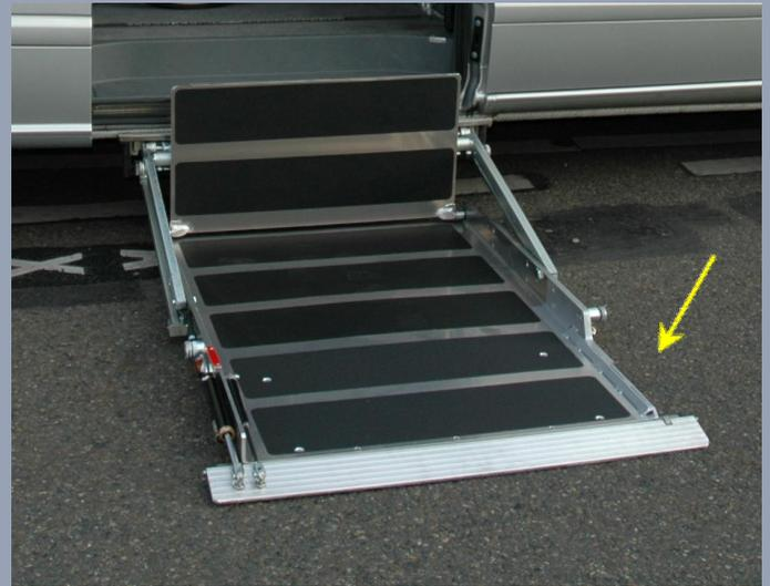
OPTION : La découpe latérale du plateau permet de faciliter une sortie sur le côté, lorsque que la plateforme se trouve près d'un obstacle.
