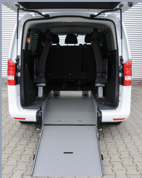
Système Easy-Flex breveté, la rampe se rabat et devient le fond de votre coffre.
