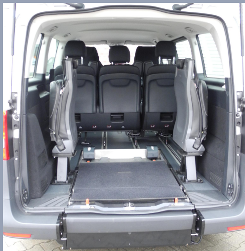
Système Easy-Flex breveté, la rampe se rabat et devient le fond de votre coffre.
